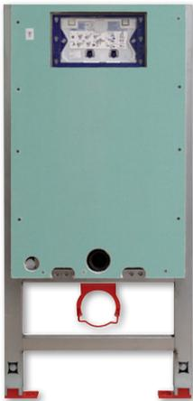
**Module** sind zur Aufnahme der Keramiksanitärkörper WC, Waschtisch, Bidet und Urinal bestimmt. Sie bestehen aus einer selbsttragenden, verzinkten Stahlkarosserie und beinhaltet alle Anschlüsse und Spüleinrichtungen. In der mitgelieferten GKFI-Bauplatte sind alle nötigen Regeldurchbrüche und Bohrungen enthalten.
