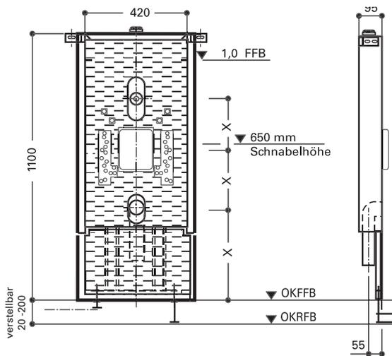
geeignet für: Mauerwerk, Trockenbau, Vorwand
