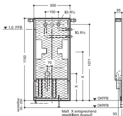
geeignet für: Mauerwerk, Trockenbau, Vorwand
