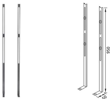
Montagehilfe für die freistehende Montage der Kombiset Urinal-Elemente bzw. zur Lastaufnahme der Urinal-Keramik.
