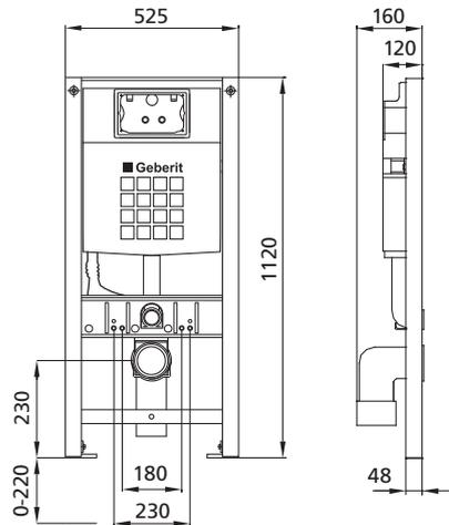
geeignet für: Trockenbau und Vorwand
