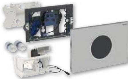
Vandalensichere Spülsteuerung zur Nachrüstung oder Neumontage für den öffentlichen und privaten Bereich. Für Geberit UP-Spülkasten Sigma geeignet. Die Auslösung erfolgt automatisch/berührungslos, über einen Infrarotsensor als auch durch Annäherung mit der Hand als 1-Mengen oder 2-Mengenspülung.
