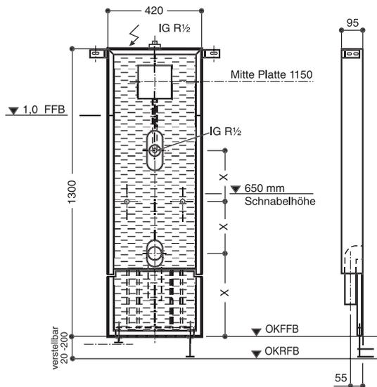
geeignet für: Mauerwerk, Trockenbau, Vorwand
