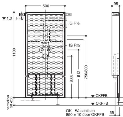
geeignet für: Mauerwerk, Trockenbau, Vorwand
