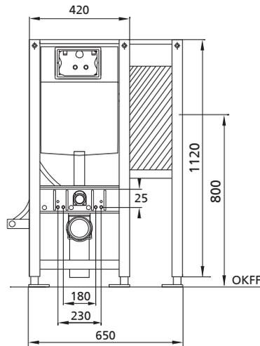
geeignet für: Trockenbau und Vorwand
