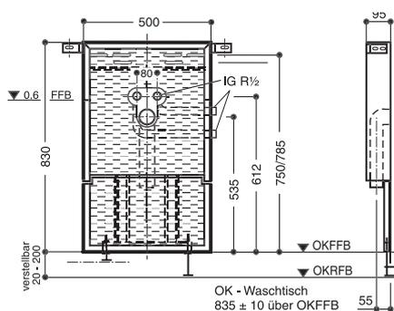
geeignet für: Mauerwerk, Trockenbau, Vorwand
