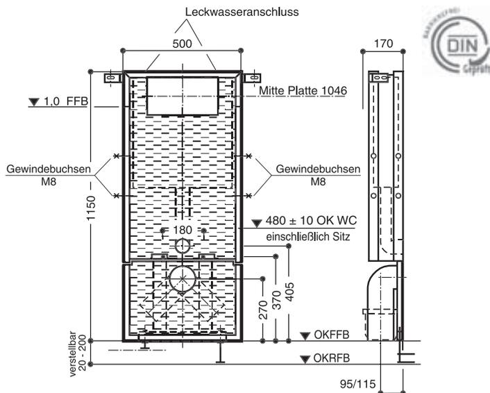
geeignet für: Mauerwerk, Trockenbau, Vorwand
