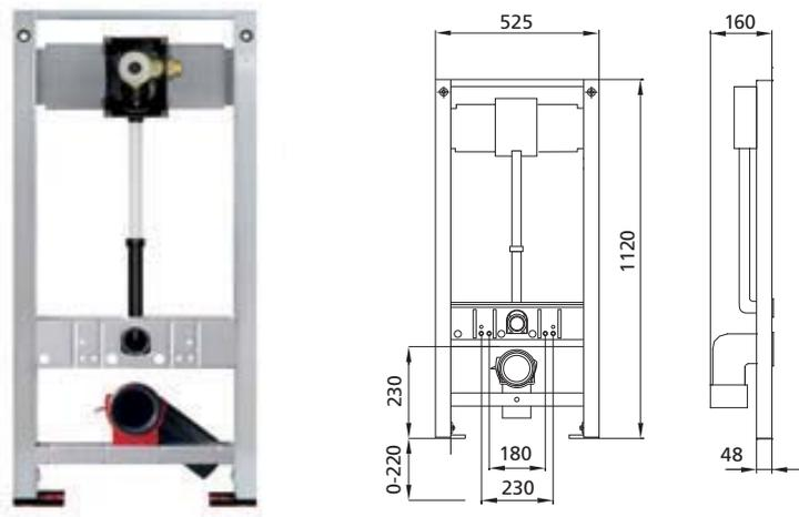
geeignet für: Trockenbau und Vorwand
