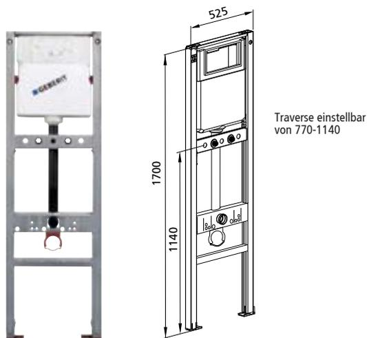
geeignet für: Trockenbau und Vorwand
