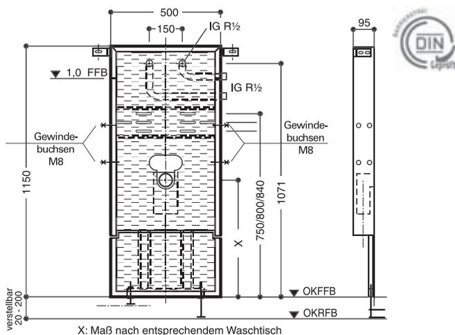
geeignet für: Mauerwerk, Trockenbau, Vorwand
