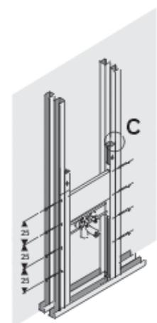
Ausgerichtete Ständerwand Elementkombination seitlich und am Fußboden verschrauben.
