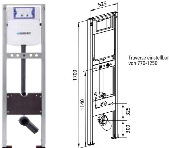
geeignet für: Trockenbau und Vorwand
