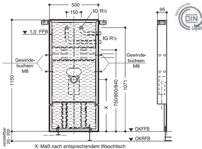
geeignet für: Mauerwerk, Trockenbau, Vorwand
