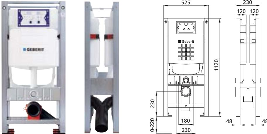
geeignet für: Trockenbau
