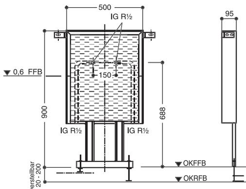
geeignet für: Mauerwerk, Trockenbau, Vorwand
