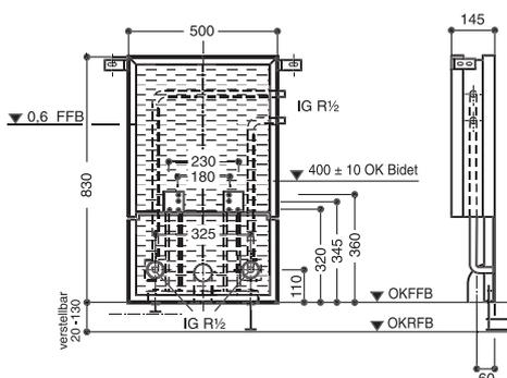
geeignet für: Mauerwerk, Trockenbau, Vorwand
