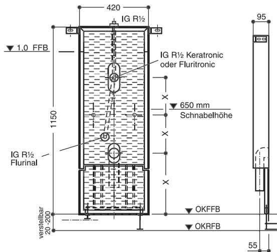
geeignet für: Mauerwerk, Trockenbau, Vorwand
