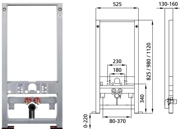
geeignet für: Trockenbau und Vorwand
