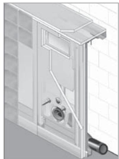
6. Beplanken Sie diese Konstruktion mit für den Feuchtraum geeignete Gipskartonplatten. Die Beplankung muss immer spaltfrei und doppelt erfolgen! Im WC-Bereich muss zusätzlich verschraubt werden!
