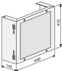
Zusatzausstattung für Burda M-Block Typ WC, DIN geprüft barrierefrei, zur nachträglichen Montage von Wand- und Stützklappgriffen.
