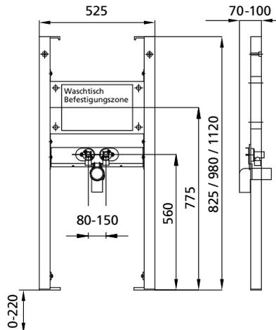
geeignet für: Trockenbau und Vorwand
