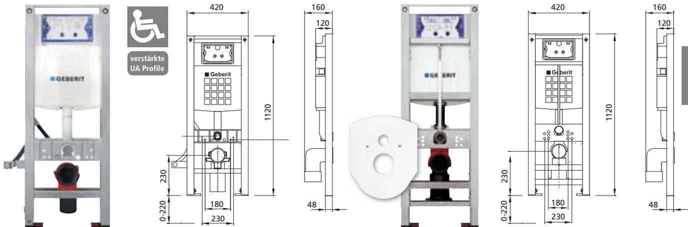
geeignet für: Trockenbau und Vorwand
