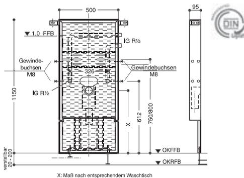
geeignet für: Mauerwerk, Trockenbau, Vorwand
