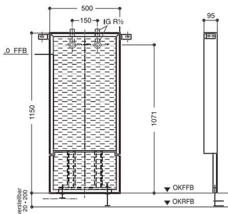
geeignet für: Mauerwerk, Trockenbau, Vorwand
