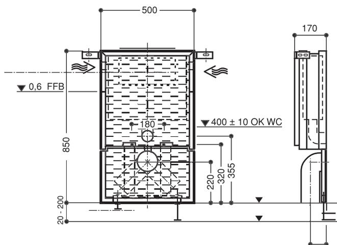
geeignet für: Mauerwerk, Trockenbau, Vorwand
