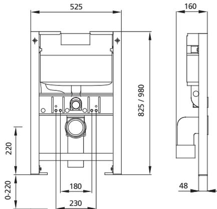
geeignet für: Trockenbau und Vorwand
