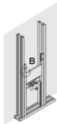
Meterriss auf der Ständerwand fluchtend mit der Markierung auf dem Element ausrichten. (B)
