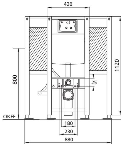
geeignet für: Trockenbau und Vorwand
