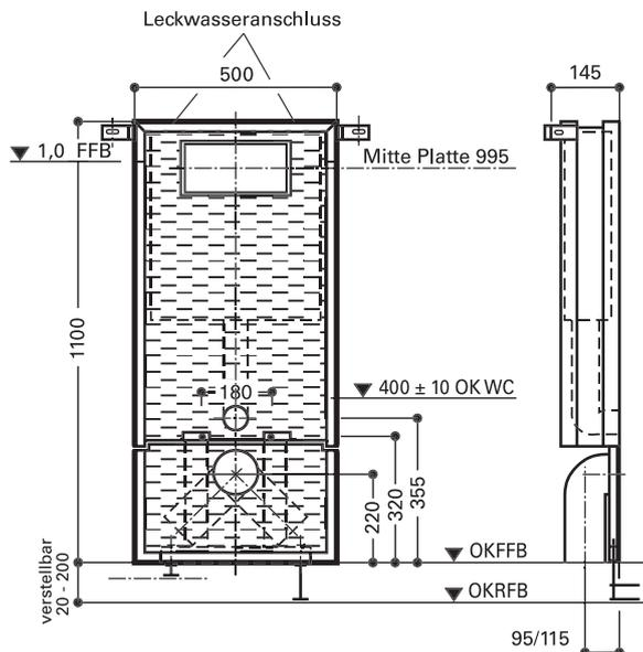
geeignet für: Mauerwerk, Trockenbau, Vorwand
