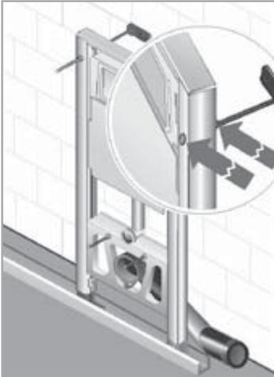
1. Befestigen Sie ein U-Profil am Boden im gewünschten Abstand zur Wand und stellen Sie das BS+ Element hinein. Montieren Sie die beiden als Zubehör mitbestellten Wandwinkel an das BS+ Element und justieren Sie den Abstand des Elementes mit Hilfe der Wandwinkel. Richten Sie die Wandwinkel nach unten oder zur Seite aus. Längen Sie die Gewindestangen so ab, dass sie nicht mehr aus dem Element herausragen. Ziehen Sie die Kontermuttern an.
