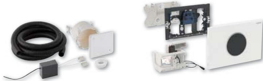
Vandalensichere Spülsteuerung zur Nachrüstung oder Neumontage für den öffentlichen und privaten Bereich. Für Geberit UP-Spülkasten Sigma geeignet. Die Auslösung erfolgt automatisch/berührungslos, über einen Infrarotsensor als auch durch Annäherung mit der Hand als 1-Mengen oder 2-Mengenspülung.
