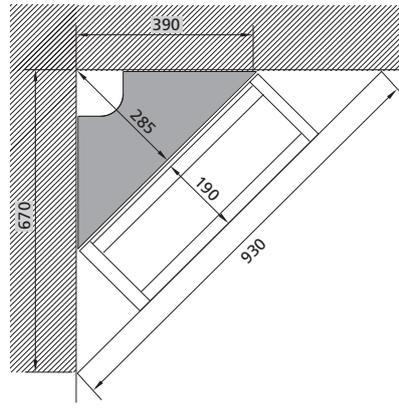
Für die Übereckmontage von Modulen
