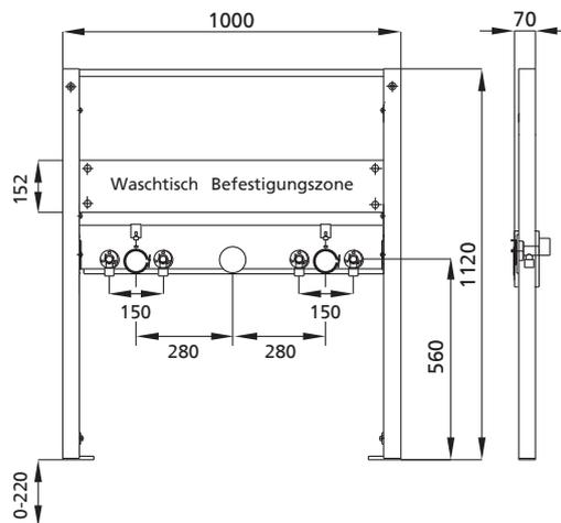
geeignet für: Trockenbau und Vorwand
