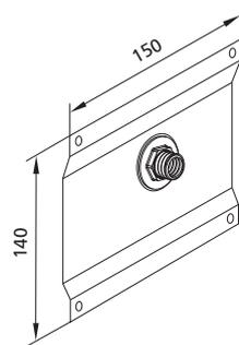
Zur Befestigung mittels Distanzschienen (677 034) zwischen 2 Sanitär-Modulen oder zwischen Modul und Zwischenträger oder nur zwischen Zwischenträger oder in einem Schachtelement .
