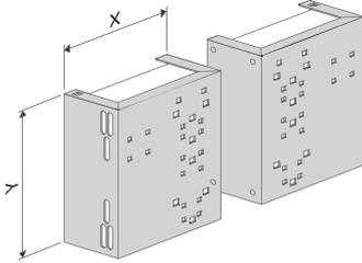
Zusatzausstattung für Burda M-Block Typ WC, DIN geprüft barrierefrei. Einschl. Montagezubehör für Befestigungsplatte und einschl. Montagezubehör aus rostfreiem Edelstahl zur Griffbefestigung. Abmessung: 165 x 260 mm
