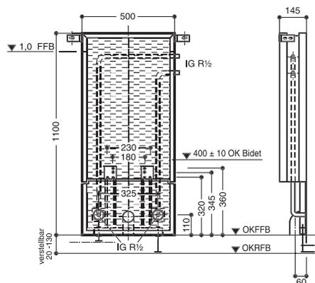
geeignet für: Mauerwerk, Trockenbau, Vorwand
