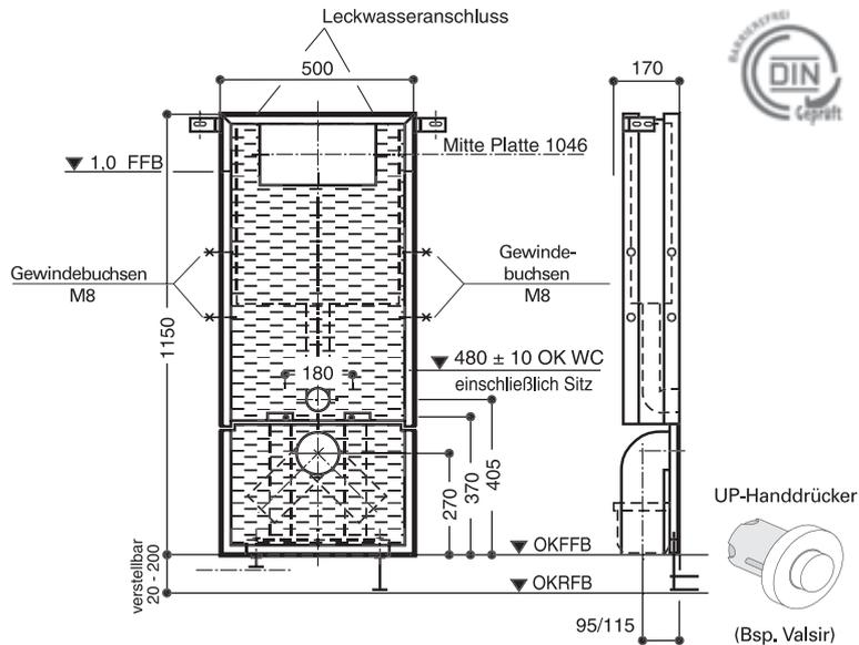
geeignet für: Mauerwerk, Trockenbau, Vorwand
