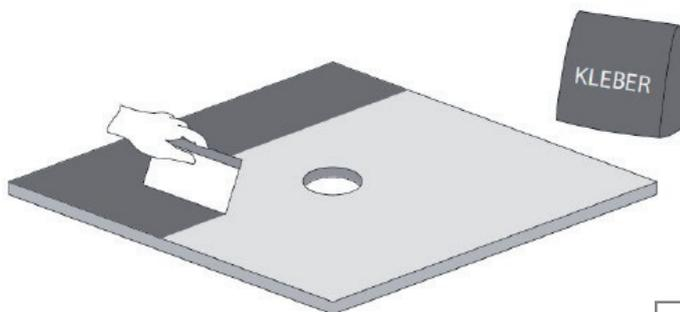
Herstellen eines planen Untergrunds. Evtl. Rohrführungsschächte sind mit Füllmaterial aufzufüllen. Auf der Unterseite vom Planopor wird mit einem 8 mm Zahnpachtel ein vergüteter Dünnbettmörtel aufgetragen. ( Güteklasse C2 )
