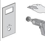
Beplankung anpassen, Ausschnitte anfertigen, Beplankung befestigen.
