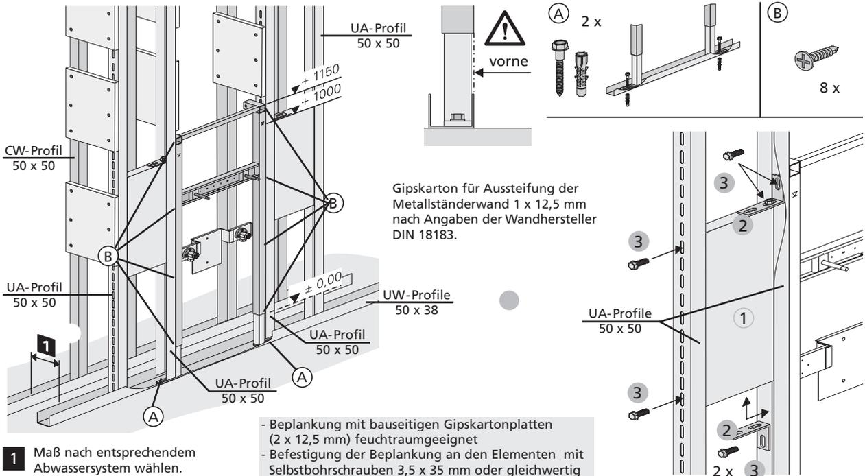
2. Vorwandssystem mit Leichtbauprofilen
